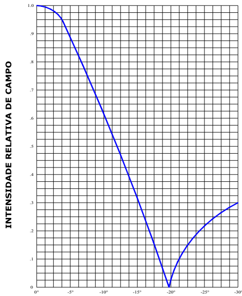
DIAGRAMA DE RADIAÇÃO VERTICAL Escala E/Emax 3 Elementos
